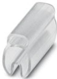
Porta-identificação de condutor, transparente, não impresso, tipo de montagem: inserir, faixa de diâmetro de cabo: 4-7 mm, tamanho para gravação: 15 x 4 mm
