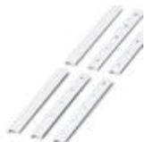
Tira Zack plana, Fitas, branco, não impresso, identificável com: Plotter, Tipo de montagem: Travamento em ranhura plana de plaqueta, para a largura de terminal: 12 mm, Tamanho para gravação: 5,15 x 12,15 mm
