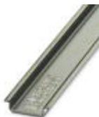
Trilho de fixação com perfil em U, material: aço, não perfurado, altura 7,5 mm, largura 35 mm, comprimento: 2 m
