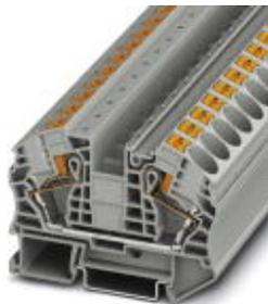
Borne de passagem, Tipo de conexão: Conexão Push-in, Bitola: 0,5 mm<sup>2</sup> - 25 mm<sup>2</sup>, AWG: 20 - 4, Largura: 12,2 mm, Cor: cinza, Tipo de montagem: NS 35/7,5, NS 35/15
