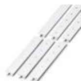
Marcador de terminais, Fitas, branco, identificado, impresso horizontalmente: L1, L2, L3, N, PE, Tipo de montagem: Travamento em ranhura elevada de plaqueta, para a largura de terminal: 12,2 mm, Tamanho para gravação: 10,5 x 12,15 mm
