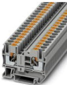
Borne de passagem, Tipo de conexão: Conexão Push-in, Bitola: 0,5 mm<sup>2</sup> - 10 mm<sup>2</sup>, AWG: 20 - 8, Largura: 8,2 mm, Altura: 42,2 mm, Cor: cinza, Tipo de montagem: NS 35/7,5, NS 35/15
