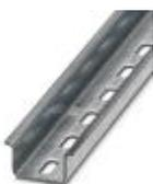
Trilho de fixação com perfil em U, material: galvanizado, perfurado, altura 15 mm, largura 35 mm, comprimento: 2 m
