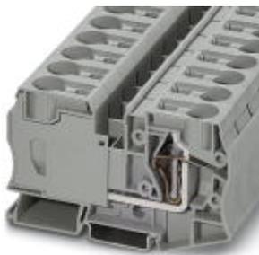
Borne de passagem, Tipo de conexão: conexão à mola, Bitola: 2,5 mm<sup>2</sup> - 35 mm<sup>2</sup>, AWG: 14 - 2, Largura: 16 mm, Cor: cinza, Tipo de montagem: NS 35/7,5, NS 35/15
