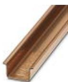
Trilho de fixação com perfil em U, material: cobre, não perfurado, 15 mm de espessura, altura 15 mm, largura 35 mm, comprimento: 2 m
