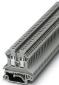
Borne de passagem, Tipo de conexão: Conexão a parafuso, Bitola: 0,2 mm<sup>2</sup> - 4 mm<sup>2</sup>, AWG: 24 - 12, Largura: 5,2 mm, Cor: cinza, Tipo de montagem: NS 35/7,5, NS 35/15, NS 32
