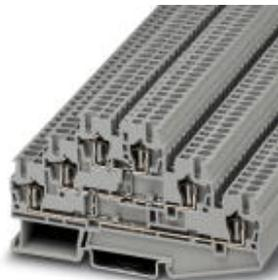
Borne de vários andares, Tipo de conexão: conexão à mola, Bitola: 0,08 mm<sup>2</sup> - 4 mm<sup>2</sup>, AWG: 28 - 12, Largura: 5,2 mm, Cor: cinza, Tipo de montagem: NS 35/7,5, NS 35/15
