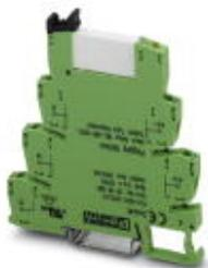
Interface CLP, composto de borne básico CLP-BSC.../21 com conexão a parafuso e relé miniatura plugável com contato de potência para montagem sobre trilho de fixação NS 35/7,5, 1 inversor, tensão de entrada 24 V DC
