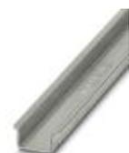
Trilho de fixação com perfil em U, material: aço, não perfurado, 2,3 mm de espessura, altura 15 mm, largura 35 mm, comprimento: 2 m
