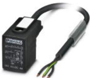
Cabo sensor/atuador, 3-pólos, PUR livre de halogênio, preto acinzentado RAL 7021, extremidade livre do condutor, para Conector de válvula B (10 mm), com 1 LED, ligado com Varistor, Comprimento de cabo: 1,5 m
