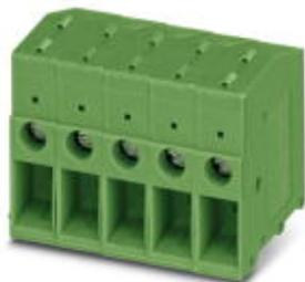
Terminal de p. placa de circuito impresso, Corrente nominal: 32 A, Tensão nominal: 630 V, Medida do passo: 7,62 mm, Número de pólos: 1, Tipo de conexão: Conexão por rosqueamento frontal, Montagem: Solda por onda, Sentido de conexão Conductor/platina: 0 °, Cor: verde, O produto pode ser alinhado com diversos números de polos!
