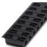
Header, Corrente nominal: 12 A, Tensão de dimensionamento (III/2): 320 V, Número de pólos: 12, Medida do passo: 5,08 mm, Cor: preto, Superfície de contato: Estanho, Montagem: THR solda, As informações para o usuário e recomendações de especificação sobre a tecnologia Through Hole Reflow encontram-se em "Downloads"
