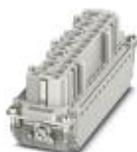
Contato fêmea, Tamanho: B24, Número de pólos: 24+PE, Soquete, Conexão Push-in, 500 V, 16 A, 0,14 mm<sup>2</sup> ... 2,5 mm<sup>2</sup>, Aplicação: Potência
