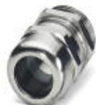
Conexão para cabos, Material da conexão roscada: Latão, niquelado, Diâmetro externo do cabo 15 mm ... 21 mm, Blindagem: não, Rosca de conexão: M32, Cor: prata
