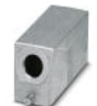
Carcaça B24, para trava simples, Material: Alumínio fundido sob pressão, resistente à água do mar, Saídas de cabos: 1, lateral, Altura: 60 mm, Conexão para cabos: sem, Conexão: não, 1x M32, Padrão
