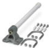
Antena omnidirecional, 2,4 GHz, 6 dBi, linear vertical, ângulo de abertura h/v 360°/20°, N (fêmea), IP65, resistente à água do mar
