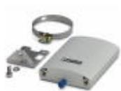
Antena radioelétrica, grau de proteção IP55, rendimento 8 dBi, linear vertical, SMA (fêmea), impedância 50  $\Omega$ , ângulo de abertura h/v 75°/70°
