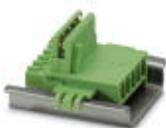
Plugue conector, Corrente nominal: 8 A, Corrente nominal (Ex): 8 A, Tensão nominal (Ex): 125 V, Número de pólos: 5, Medida do passo: 3,81 mm, Artigo com contatos dourados, conectores de bus para conectar a caixas eletrônicas
