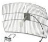
Antena parabólica, IP55, rend. 19 dBi, linear vert., conexão N (fêmea), imped. 50 $\Omega$ , âng. abert. h/v 17°/11°
