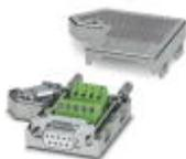
Conector D-SUB, soquete de 9 polos, uma entrada de cabos inferior a 35°, tipo universal para todos os sistemas, configuração de pinos: 1, 2, 3, 4, 5, 6, 7, 8, 9 sobre terminal de conexão por rosqueamento
