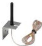
Antena omnidirecional, 2,4 GHz, 2 dBi, linear vertical, cabo de 1,5 m, MCX (macho), IP65, impedância: 50 Ω
