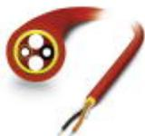
Cabo de fibra de polímero, duplex 980 µm / 1000 µm, versão pesada para instalação interna fixa. em metros sem conector
