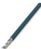
Cabo CAT5-SF/UTP (J-LI02YS(ST)C H 2 x 2 x 26 AWG), cabo de instalação leve flexível 2 x 2 x 0,14 mm<sup>2</sup>, fio fino, blindado, revestimento externo: 5,75 mm ± 0,15 mm de diâmetro
