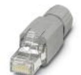
Conector RJ45, Grau de proteção: IP20, Número de pólos: 8, 1 GBit/s, CAT5 (IEC 11801:2002), Material: PA, Tipo de conexão: Conexão rápida IDC, Perfil de conexão: AWG 26-23, Saída para cabo: reto
