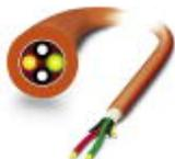
Cabo de instalação PCF montável e robusto, para disposição interior com elementos de alívio de tensão de aramida de elevada resistência. Elementos individuais de material FRNC altamente flexível. Sem halogênio, resistente à exposição ao ozono e UV com revestimento exterior robusto em poliuretano (PUR).
