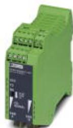
Conversor de fibra óptica com diagnóstico óptico integrado, contato de alarme, para sistema de bus RS-485 de 2 fios (SUCONET K, Modbus ...) até 500 kBit/s, codificação NRZ, acoplador T com duas interfaces de fibra óptica (FSMA), 660 nm, para cabo de fibra polimérica/PCF
