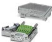
Conector D-SUB, soquete de 9 polos, duas entradas de cabos inferiores a 35°, sistema de bus: MODBUS, MODBUS-PLUS, BITBUS, ARCNET, MULT/MININET(B&R), SYSTEM 2003(B&R), P-NET, configuração de pinos: 1, 2, 3, 5, 6, 8; terminais de conexão por rosqueamento
