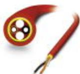
Cabo de instalação POF montável e robusto, para disposição fixa no interior. Concebido para elevados requisitos em termos de tração e compressão lateral, com elementos individuais fabricados a partir de poliamida (PE) altamente resistente. Sem halogênio, resistente à exposição ao ozono e UV com revestimento exterior em poliuretano reforçado (PUR).
