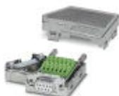
Conector D-SUB, 9 polos, soquete, duas entradas de cabos inferiores a 35°, sistema de bus: MODBUS, CEGELEC, configuração de pinos: 1, 1, 2, 3, 6, 7; terminais de conexão por rosqueamento
