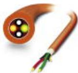
Cabo de instalação PCF montável e robusto (apenas cabeças IP20) para disposição interior com elementos de alívio de tensão de aramida de elevada resistência. Elementos individuais de material FRNC altamente flexível. Sem halogênio, resistente à exposição ao ozono e UV com revestimento exterior robusto em poliuretano (PUR).
