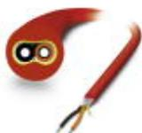
Cabo de instalação POF montável para disposição fixa no interior com elementos individuais fabricados com poliamida (PE) de alta resistência. Sem halogênio, resistente à exposição ao ozono e UV com revestimento exterior robusto em poliuretano (PUR).
