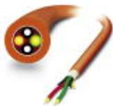
Cabo de instalação PCF montável e robusto, para disposição interior com elementos de alívio de tensão de aramida de elevada resistência. Elementos individuais de material FRNC altamente flexível. Sem halogênio, resistente à exposição ao ozono e UV com revestimento exterior robusto em poliuretano (PUR).
