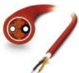
Cabo redondo POF montável e altamente flexível, para aplicação em correia de arraste para uma frequência de torção alternada máx. de 5 mil milhões de ciclos com elementos individuais fabricados de poliamida (PE) altamente resistente. Sem halogênio, resistente à exposição ao ozono e UV com revestimento exterior robusto em poliuretano (PUR).
