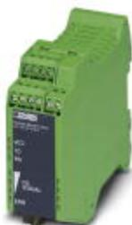
Conversor de fibra óptica com diagnóstico óptico integrado, contato de alarme, RS-422/RS-485 de 4 fios/ INTERBUS até 2 MBit/s, equipamento final com uma interface de fibra óptica (FSMA), 660 nm, para cabo de fibra polimérica/PCF
