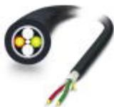
Cabo redondo PCF montável e altamente robusto (apenas para cabeças IP20) para colocação externa com barreira de vapor integrada e camada de fio de vidro à prova de roedores. Elementos individuais de material FRNC altamente flexível. Resistente à exposição ao ozono e UV, com revestimento exterior altamente robusto em polietileno.
