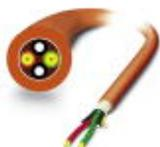
Cabo de instalação GOF montável e robusto (apenas cabeças IP20), para disposição interior com elementos de alívio de tensão de aramida de elevada resistência. Elementos individuais fabricados a partir de material FRNC altamente flexível. Sem halogênio, resistente à exposição ao ozono e UV com revestimento exterior robusto em poliuretano (PUR).
