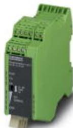
Conversor fibra óptica c/ diagn. óptico integrado, contato alarme, p/ sistemas Bus RS-485 2 condutores (SUCONET K, MODBUS ...) até 500 kBit/s, codificação NRZ, dispos. terminal c/ 1 interface fibra óptica (SC-duplex), 1300 nm, p/ cabo fibra de vidro
