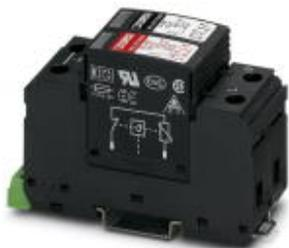
Proteção contra surtos para redes de alimentação com 3 condutores (L1, N, PEN), composto de base com contato FM e plugues de proteção, para montagem sobre NS 35.
