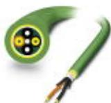
Cabo de fibra PROFINET-HCS-GI, duplex 200/230  $\mu\text{m}$ , largura de banda elevada especial para aplicações Ethernet. Robusto revestimento externo em PUR. Versão pesada, adequada para porta-cabos, para instalação interna, em metros, sem conector
