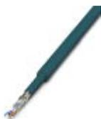
Cabo CAT5e-SF/UTP (J-02YS(ST)C HP 2 x 2 x 24 AWG), cabo de instalação pesado 2 x 2 x 0,22 mm<sup>2</sup>, condutor maciço, blindado, revestimento externo: 7,8 mm de diâmetro, revestimento interno: 5,75 mm ± 0,15 mm de diâmetro
