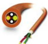
Cabo de instalação GOF montável e robusto, para disposição interior com elementos de alívio de tensão de aramida de elevada resistência. Elementos individuais fabricados a partir de material FRNC altamente flexível. Sem halogênio, resistente à exposição ao ozono e UV com revestimento exterior robusto em poliuretano (PUR).
