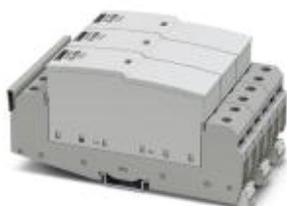
Dispositivo de proteção contra raios plugável, conforme tipo 1/classe I, com fusível à prova de corrente de surto integrado, para redes de fornecimento de energia trifásicas com PE e N instalados de forma combinada em um condutor (L1, L2, L3, PEN).
