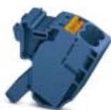
Borne para detector, tipo de conexão: Conexão Push-in, quantidade de conexões: 2, perfil de conexão: 0,5 mm<sup>2</sup> - 16 mm<sup>2</sup>, AWG: 20 - 6, largura: 18,5 mm, altura: 34,7 mm, cor: azul, tipo de montagem: na base
