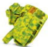
Borne para detector, tipo de conexão: Conexão Push-in, quantidade de conexões: 2, perfil de conexão: 0,5 mm<sup>2</sup> - 16 mm<sup>2</sup>, AWG: 20 - 6, largura: 18,5 mm, altura: 34,7 mm, cor: verde/amarelo, tipo de montagem: na base
