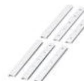
Tira Zack plana, Fitas, branco, não impresso, identificável com: CMS-P1-PLOTTER, PLOTMARK, Tipo de montagem: Travamento em ranhura plana de plaqueta, para a largura de terminal: 10 mm, Tamanho para gravação: 5,15 x 10 mm
