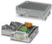
Conector D-SUB, 9 polos, pino, duas entradas de cabos inferiores a 35°, sistema de bus: PROFIBUS DP até 12 MBit/s, resistor de terminação comutável via comutador deslizante, alocação de pinos: 3, 5, 6, 8; terminais de conexão por força de mola
