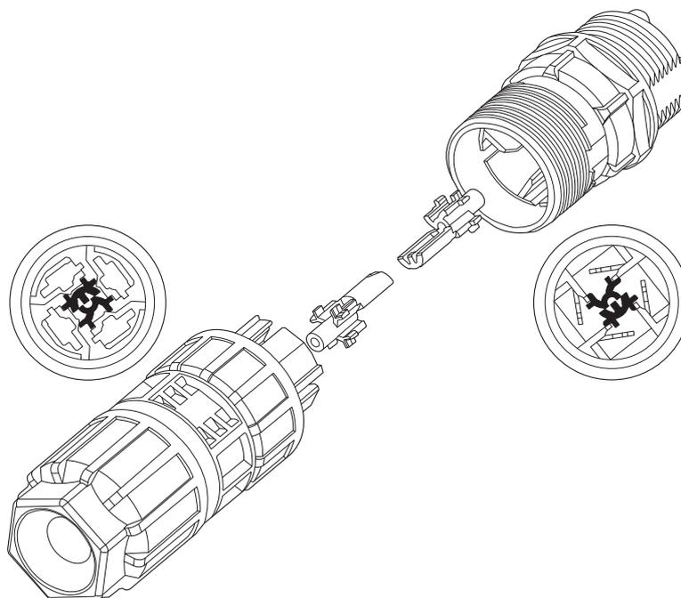
Codificação do conector de encaixe QUICKON
