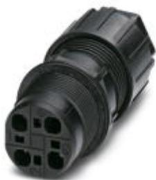
Passagem de parede, Conexão QUICKON, Número de pólos: 3+PE, 1 mm<sup>2</sup> ... 2,5 mm<sup>2</sup>, 690 V, 20 A, preto, com porca do parafuso QUICKON, Diâmetro de cabo: 6 mm ... 10 mm, Rosca de montagem: M25, Conexão Push-in, 2,5 mm<sup>2</sup>
