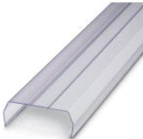
Perfil de cobertura para cobrir barras de terminais, é encaixado no suporte de perfil de cobertura APT-ME ou no suporte terminal APH-ME. Nas extremidades e nos intervalos de aprox. 40 cm deve-se colocar um suporte de perfil de cobertura. Comprimento conforme desejado pelo cliente.
