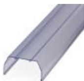
Perfil de cobertura, para réguas de borne, encaixe sobre AP 3-TU, AP 3-TNS 35, identificável com tiras de encaixe AP-ES. Nas extremidades e nos intervalos de 40 cm deve-se colocar um suporte para perfil de cobertura. Comprimento de fornecimento: comprimento desejado pelo cliente
