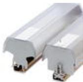
Perfil de proteção, para proteger as réguas de bornes é sobreposto em porta-perfis de proteção AP 3-TU, AP 3-TNS 35, que podem ser inscritos com tiras de encaixe AP-ES. Nas extremidades e nos intervalos de ca. de 40 cm, deve-se colocar um porta-perfil de proteção. Comprimento de fornecimento: 1 m
