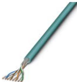
Cabo CAT5e-S/UTP, 4 x 2 x 26 AWG, flexível (7 fios), blindado, revestimento externo: PUR sem halogênio, diâmetro externo 6,1 mm, RAL 5021 (azul), em metros
