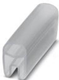
Porta-identificação de condutor, transparente, não impresso, tipo de montagem: inserir, faixa de diâmetro de cabo: 2-4 mm, tamanho para gravação: 18 x 4 mm
