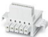
Plugue conector, corrente nominal: 8 A, corrente nominal (Ex): 8 A, tensão nominal (Ex): 125 V, número de polos: 5, passo: 3,81 mm, cor: cinza claro, superfície de contato: Ouro, Artigo com contatos dourados, conectores de bus para conectar a caixas eletrônicas
