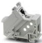
Adaptador para trilho de fixação, grau de proteção: IP20, número de polos: 8, 1 GBit/s, CAT6, material: PC-GF, tipo de conexão: Conexão rápida IDC, bitola de conexão: AWG 24- 22, cor: cinza
