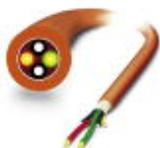
Cabo de instalação PCF montável e robusto (apenas cabeças IP20) para disposição interior com elementos de alívio de tensão de aramida de elevada resistência. Elementos individuais de material FRNC altamente flexível. Sem halogênio, resistente à exposição ao ozono e UV com revestimento exterior robusto em poliuretano (PUR).
