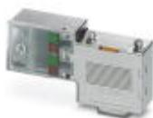
Conector D-SUB, 9 pólos, pino, saída de cabo com ângulo de 90°, sistema Bus: PROFIBUS DP até 12 MBit/s, resistor de terminação comutável externamente, configuração de pinos: 3, 5, 6, 8; tecnologia de conexão a parafuso
