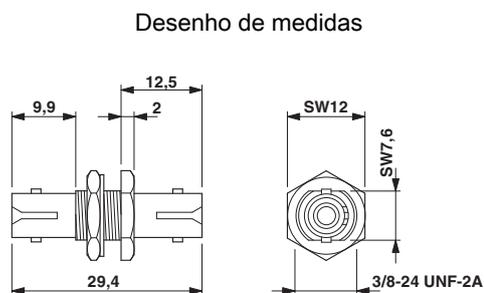
Imagem com medidas acoplamento B-FOC
