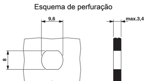
Esquema de furos passagem de parede B-FOC
