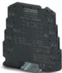
Proteção contra surtos no módulo para fixação em trilho com 6,2 mm de largura para um circuito de sinal flutuante com tecnologia de 2 condutores. Testado de acordo c/ tipos proteção contra ignição áreas Ex: Ex ia IIC / Ex iaD. Apto para HART.
