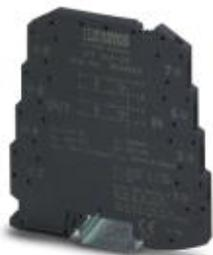
Proteção contra surtos no módulo para fixação em trilho com 6,2 mm de largura para dois circuitos de sinal flutuantes com tecnologia de 2 condutores. Testado de acordo c/ tipos proteção contra ignição áreas Ex: Ex ia IIC / Ex iaD. Apto para HART.
