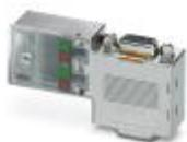
Conector D-SUB, 9 pólos, pino, saída de cabo com ângulo de 90°, sistema Bus: PROFIBUS DP até 12 MBit/s, com soquete PG-D-SUB para conexão de um dispositivo de programação, resistor de terminação comutável externamente, configuração de pinos: 3, 5, 6, 8; tecnologia de conexão a parafuso
