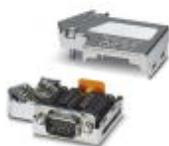
Conector D-SUB, 9 pólos, pino, saída de cabo com ângulo de 35°, sistema Bus: PROFIBUS DP até 12 MBit/s, resistor de terminação comutável externamente, configuração de pinos: 3, 5, 6, 8; tecnologia de conexão a parafuso
