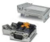
Conector D-SUB, 9 pólos, pino, saída de cabo com ângulo de 35°, sistema Bus: PROFIBUS DP até 12 MBit/s, com soquete PG-D-SUB para conexão de um dispositivo de programação, resistor de terminação comutável externamente, configuração de pinos: 3, 5, 6, 8; tecnologia de conexão a parafuso
