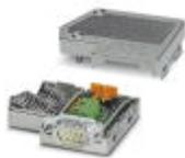
Conector D-SUB, 9 polos, pino, duas entradas de cabos inferiores a 35°, sistema de bus: PROFIBUS DP até 12 MBit/s, resistor de terminação comutável via comutador deslizante, alocação de pinos: 3, 5, 6, 8; terminais de conexão por força de mola
