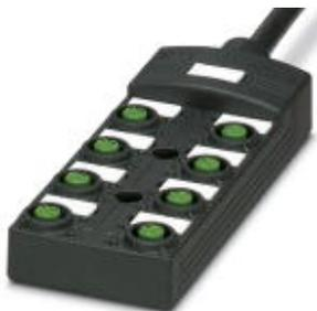
Caixa de sensor/atuador, aplicação: Padrão, tipo de conexão: Soquete M12 SPEEDCON Plástico, número de pontos de encaixe: 8, número de polos: 4, codificação: A - padrão, atribuição do ponto de encaixe: simples, indicação de estado: Sim, pnp; conexão do cabo padrão: Conexão fixa 180°, PUR/PVC, comprimento do cabo: 5 m, blindagem: não
