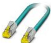
Cabo patch, CAT6<sub>A</sub>, 4 pares, blindado, conexão não cruzada (linha), confeccionado de ambos os lados com conectores de encaixe RJ45/IP20, material do revestimento: PUR, comprimento: 3,0 m
