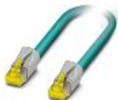
Cabo patch, CAT6<sub>A</sub>, 4 pares, blindado, conexão não cruzada (linha), confeccionado de ambos os lados com conectores de encaixe RJ45/IP20, material do revestimento: PUR, comprimento: 2,0 m
