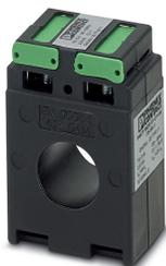
Transformador de corrente tubular, corrente primária 75 A AC; corrente secundária 5 A AC; classe de precisão 1; potência nominal 2,5 VA
