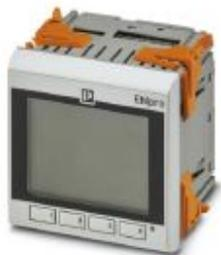
Equipamento de medição de energia multifuncional com interface Modbus/TCP integrada para a medição de parâmetros elétricos em instalações de baixa tensão até 690 V.
